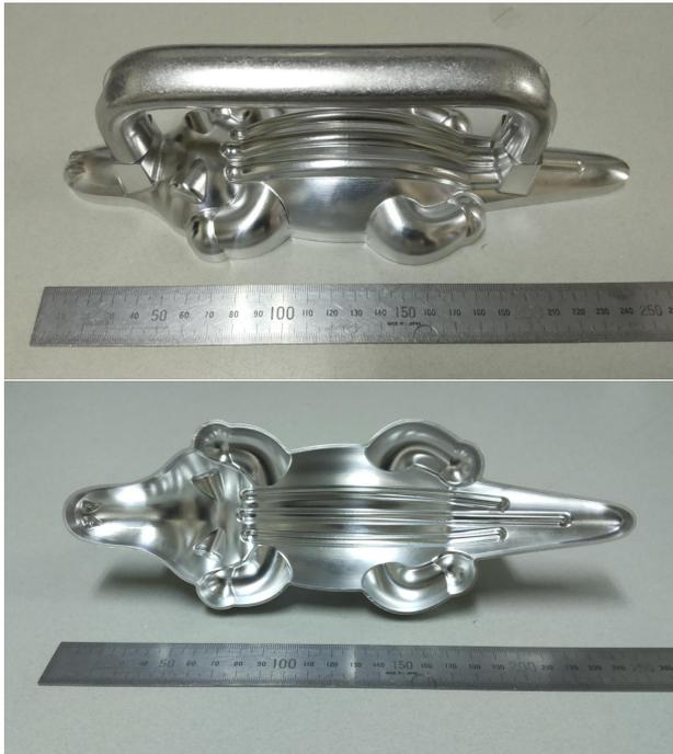
図 6: 完成したアルミ製のマチカネワニのライス型 ver.2
