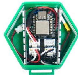
図 4: 筐体内に収められた電子回路
